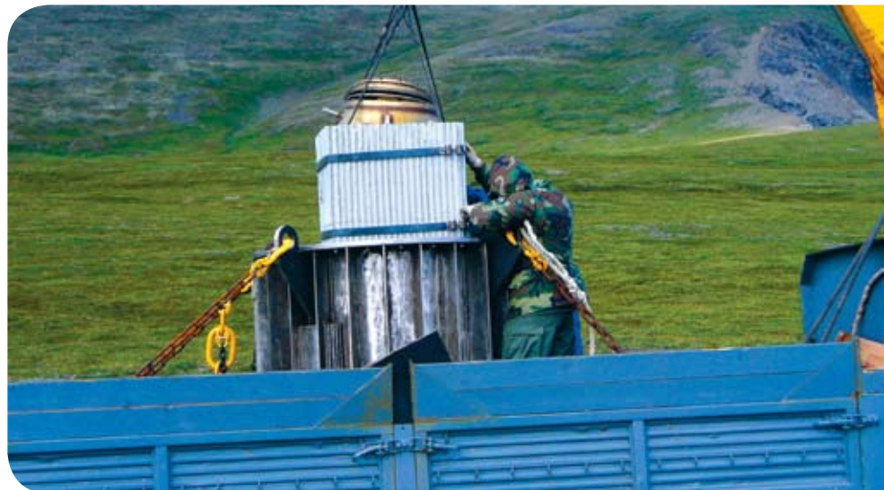
Перемещение РИТЭГа внутрь защитного контейнера
