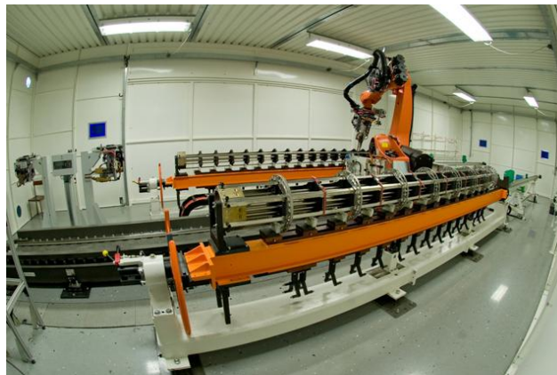
Роботизированный комплекс сборки-сварки каркасов ТВС
