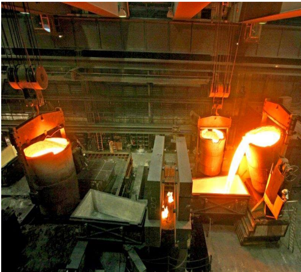
Отливка контейнера ТУК (129.0 т – 156.5 т расплава)
