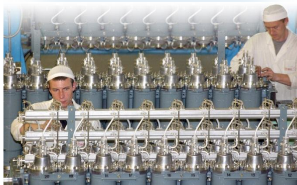
Цеха по сборке и тестированию газовых центрифуг
