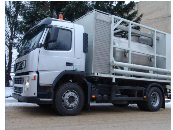
Спецавтомобили для перевозки ТРО (вверху) и ЖРО (внизу)
